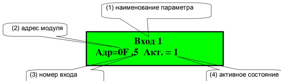
Здесь определяется физические адреса входов кондуктометрических датчиков уровня в соответствии со схемой электрической.
